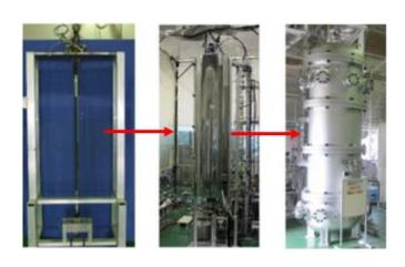
単セルスタック試験装置外観 (写真左:セルスタック、中央:電気炉、右:圧力容器)
