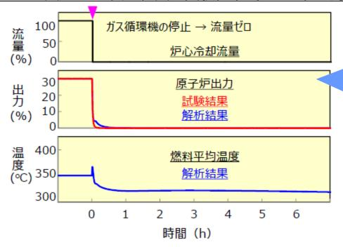
急に制御棒を引き 抜いた場合(反応 度印加)でも、負の 反応度フィードバック 特性で原子炉は安 定化している。
