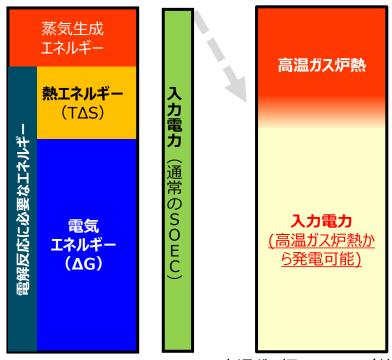
高温ガス炉+SOEC(熱アシストSOEC)
