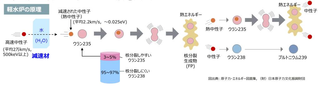
原子力発電所で使われている燃料は、**核分裂しやすい(燃えやすい)ウラン235が約4%**、核分裂しにくい (燃えにくい)ウラン238が約96%であり、セラミック状に焼き固められた小さな円柱状のペレットに加工され、燃料棒はペレットを集合させたもので、燃料集合体は燃料棒を束ねて構成される。
